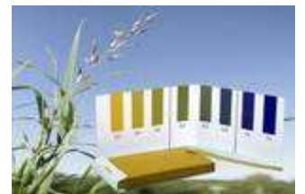
Teststreifen zum Messen von pH-Werten
